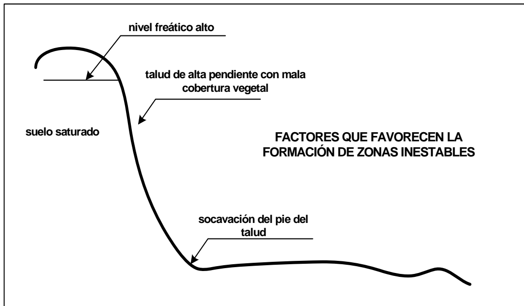
Figura 4.4. Factores que favorecen la formación de zonas inestables
