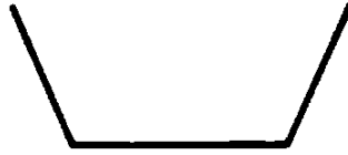
Figura 3.12. Esquema de un vertedor Cipolletti.
